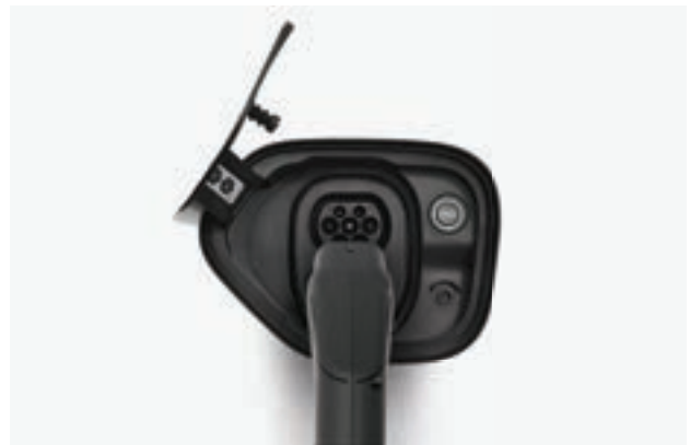
Plaats de laadkabel in de laadpoort van de wagen (maximaal 4 meter van de Two).
